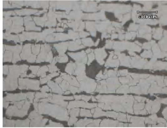
Gambar 3. Struktur Mikro Bahan Pipa
